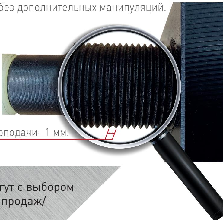
Шаг резьбы винта микроподачи- 1 мм.
